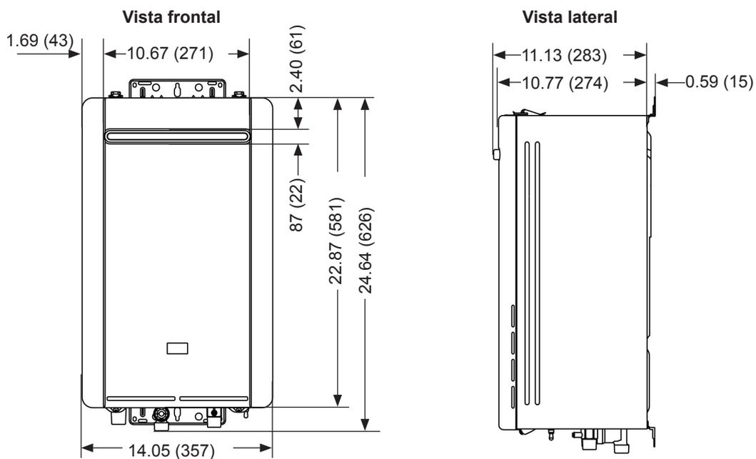
Figura 5. Dimensiones de los modelos para exteriores
