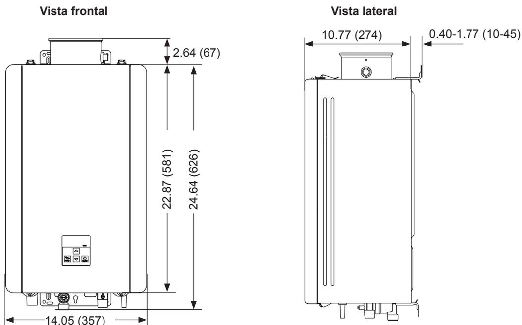
Figura 4. Dimensiones de los modelos para interiores
